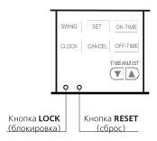
• При нажатии на кнопку "**LOCK"** все кнопки пульта ДУ будут заблокированы. Для снятия блокировки повторно нажмите кнопку "**LOCK"**.
