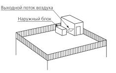
• Для обеспечения нормальной работы вентилятора блок следует устанавливать вдоль направления ветра.
